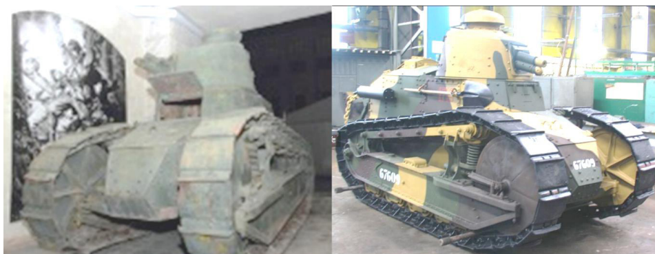
Ryc. 6. Zabytkowy czołg Renault FT-17 odnaleziony w Afganistanie – przed i po renowacji
